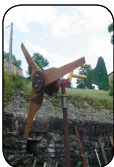
Eolienne en bois autoconstruite par Thomas Plassard
